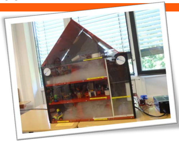
Das Rauchhaus simuliert die Ausbreitung von Brandrauch bei unterschiedlichen Türöffnungszuständen bei Bränden – eine Ableitung des richtigen Verhaltens kann spielerisch-experimentell ermittelt werden.
